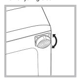
2. 通過左右旋轉可調節機腳,使 本機水平放置。本機工作面的坡 度不能超過 2 度。
