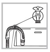
如果排水管導入浴盆或洗滌盆, 將 (隨機配備的)特製塑料件安 上,以使導管頭在排水時保持彎 曲,避免出現移位,建議將其固定 在水龍頭上。
